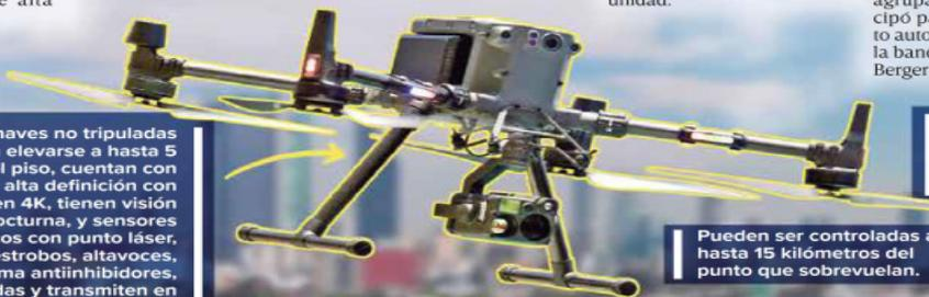
Estas aeronaves no tripuladas pueden elevarse a hasta 5 kilómetros del piso, cuentan con cámaras de alta definición con imagen en 4K, tienen visión térmica y nocturna, y sensores térmicos con punto láser, además de estrobos, altavoces, un sistema antiinhibidores, paracaídas y transmiten en tiempo real.
