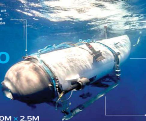
**Titán**, el sumergible tripulado, cuenta con un sistema de monitoreo que detecta en tiempo real cambios de presión y fallas en la nave.
