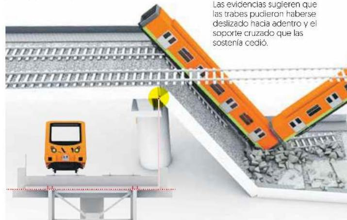
En el último viaje del tren es probable que hubiera secciones del concreto desconectadas, que simplemente descansaban sobre las traveses de acero.
