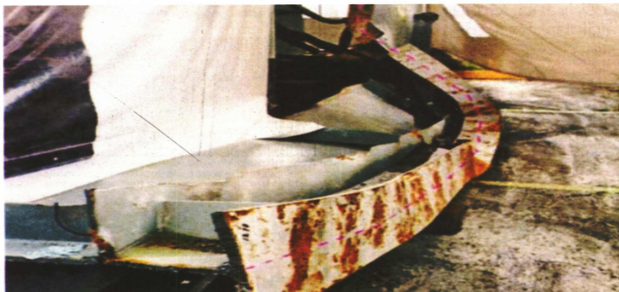
Fotografía que muestra el pandeo de la viga sur en la Línea 12 que colapsó, el pasado 3 de mayo, después de que se retiró la cubierta de concreto. Es uno de los elementos principales que aparecen en el informe final.
